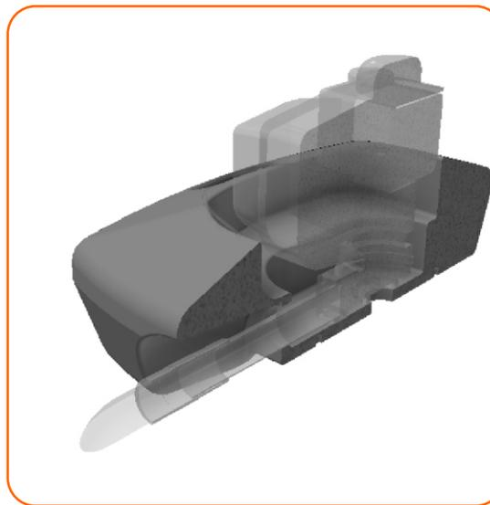
Possui uma cavidade para acomodação do motor e uma saída frontal para a mangueira de exaustão com diâmetro da sucção e saída de 1. 1/2" com vazão de 15 m<sup>3</sup>/h
