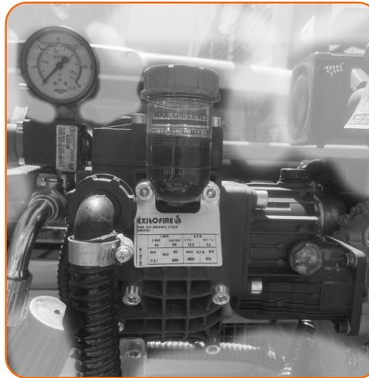
A bomba é autoescorvante, tipo membrana, com vazão 39 l/min e 40 BAR (580 PSI) de pressão. O peso aproximado é de 6,6kg.
