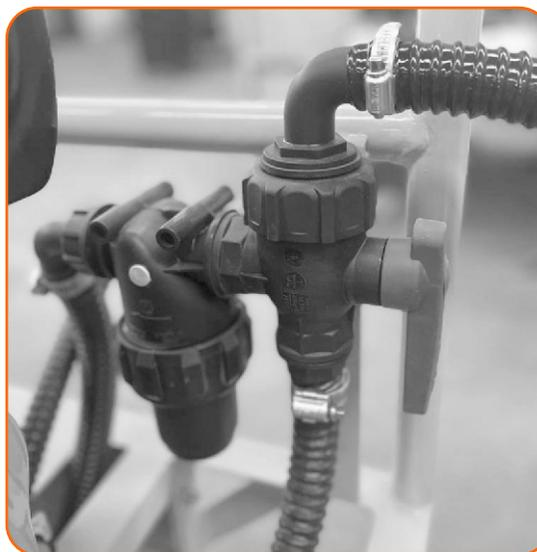
Filtro de linha (hidrojeto) permite o autoabastecimento do tanque, mangueira de 8 metros e filtro malha mínima de 80 mesh. Válvula de autoescorva: 1/4 de volta conectada na mangueira da autoescorva.
