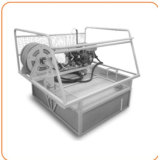
A estrutura metálica é formada por meio da união em solda MIG/TIG de cantoneiras e tubos de aço SAE 1010/20. É fixada por meio de parafusos a porcas rebite instaladas nas bordas superiores da caçamba.
