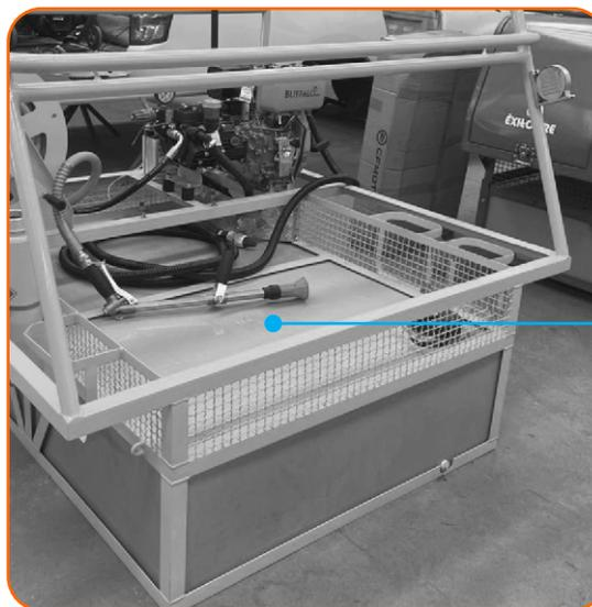
O equipamento apresenta um compartimento específico para acomodação de itens variados, que, em conjunto com a utilização de tirantes do tipo aranha, permite a adequada organização e acondicionamento de ferramentas como motosserras, sopradores, mochilas costas e outros equipamentos, contribuindo para uma melhor distribuição de peso e acessibilidade durante o uso.
