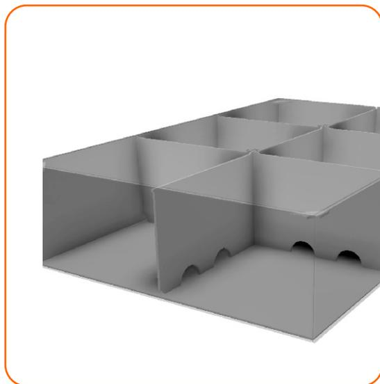
O tanque rígido é fabricado em chapas de plástico PE(polietileno) com resistência UV na cor cinza com espessura de 10mm, soldadas por processo de termo fusão.
