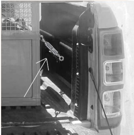
A fixação é feita através de grampo tipo esticador com corrente fixada na estrutura do tanque. Assim como, nos pontos de atraque da caçamba dos veículos, proporcionando um acoplamento rápido sem o uso de ferramentas complexas.
