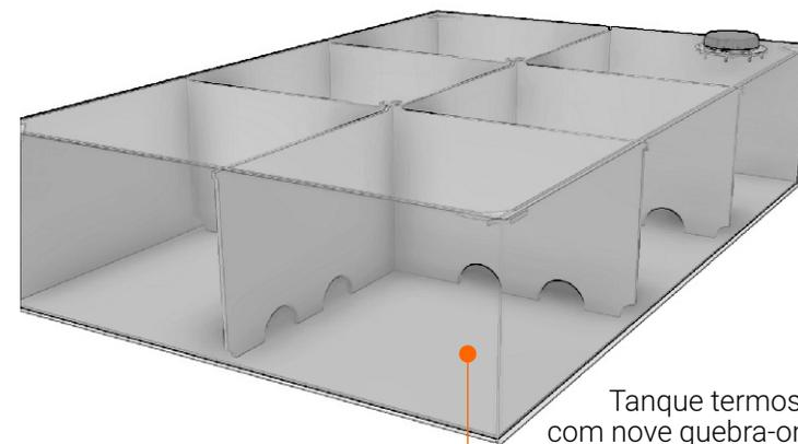
Tanque termosoldado com nove quebra-ondas interno desenhado para garantir a estabilidade e dirigibilidade do veículo.
