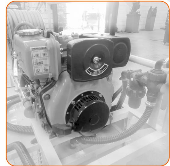
Possui motor de 4 tempos, combustível diesel/gasolina, 1 cilindro, refrigerado a ar, 7 HP com 212 cilindradas, 12 NM de torque a 2500 RPM, partida manual auto retrátil, com horímetro (opcional) para manutenção preventiva, tanque de combustível 3,6 litros, alerta de nível de óleo, e estrutura de ferro com pintura epóxi nas cores AMARELO, VERMELHO, LARANJA OU PRETO.
