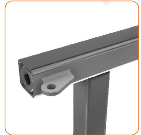
Nas extremidades superiores e inferiores de cada estrutura, são soldadas chapas de aço SAE 1010/20, cortadas a laser, em geometria que simulem o lado de uma dobradiça.
