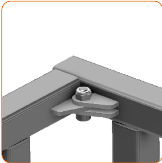
A montagem da estrutura é feita pela união dos conjuntos maiores perpendicular aos conjuntos menores, por meio da fixação em suas extremidades em formato de dobradiça por parafusos allen e porcas auto-travantes, ambos tratados por galvanização.
