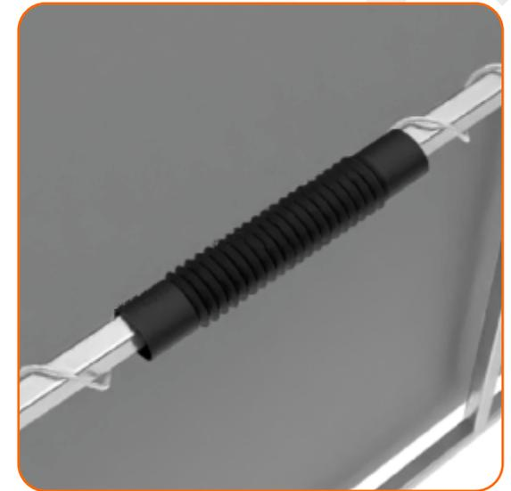
Ao meio de encontro dos conjuntos menores, possui uma capa emborrachada em formato cilíndrico sanfonado, que envolve o tubo e a dobradiça central. Sua função é evitar a danificação da lona pela proximidade do movimento da dobradiça.
