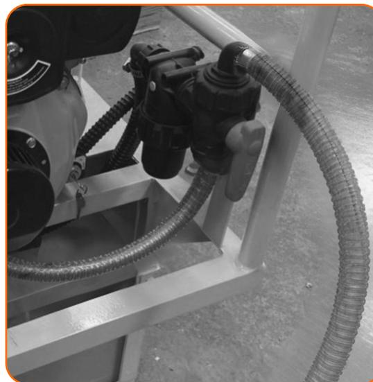
Mangueira com função de Sucção ou auto-escorva: Espiralada translúcida, diâmetro interno de 1", de 5 a 8 metros de comprimento, com filtro e flutuador na extremidade. Possuem válvula de 3 vias
