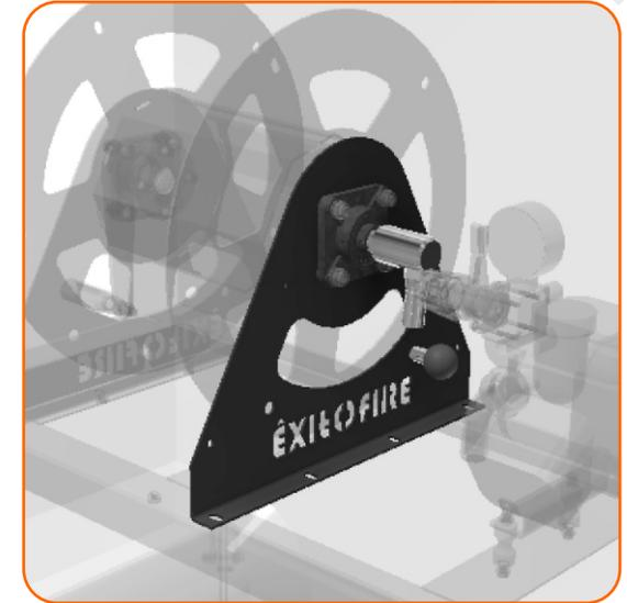
A ligação das mangueiras a bomba é proporcionada por juntas giratórias de 90°. O carretel possui uma trava manual que possibilita parar o carretel em qualquer posição de giro, isso permite utilizar a mangueira em qualquer comprimento, mesmo ainda enrolada sobre o carretel.
