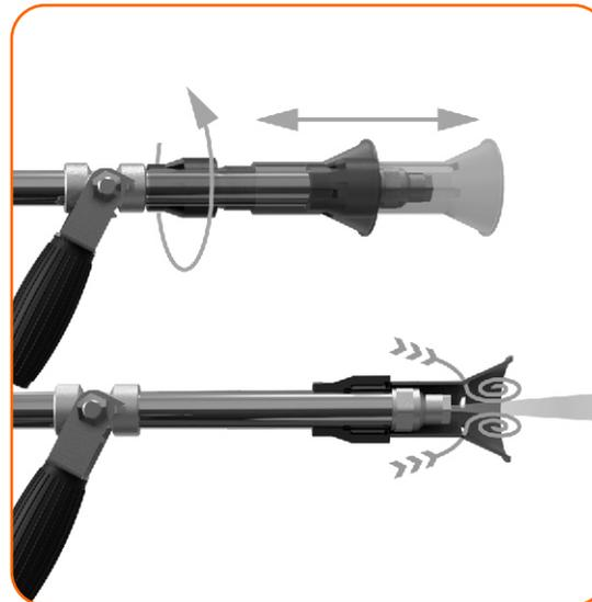
Com uma trava de ponteira que desliza, oferece regulagem de fluxo de ar, facilitando a mistura de líquidos retardantes a chama.
