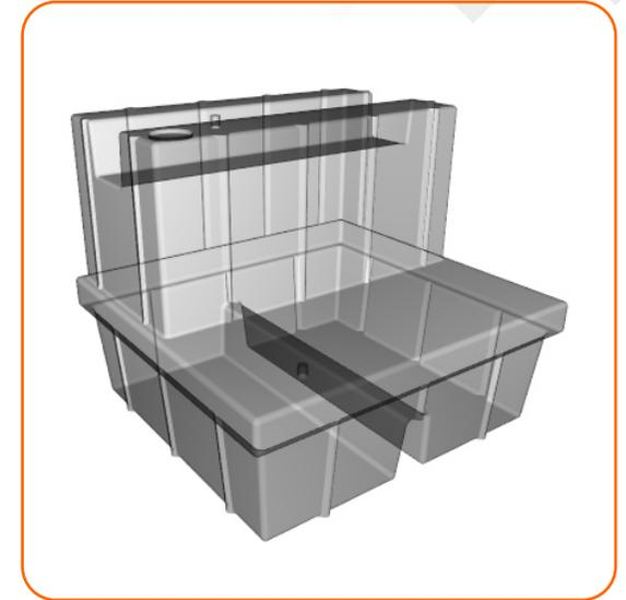
Capacidade: 600 litros. Material: Polietileno de média densidade. Espessura da parede: 9mm. Dimensões máximas do tanque: C 1.105 x L1.035 x A 1.155 mm. Formato: Em "L". Vedação hermética acoplada ao tanque com capacidade volumétrica superior a 18 L. Entalhes seccionados, sistema de quebra ondas e geometria projetada. Fixação: Cinta metálica de reforço com 4 pontos de fixação no mínimo.
