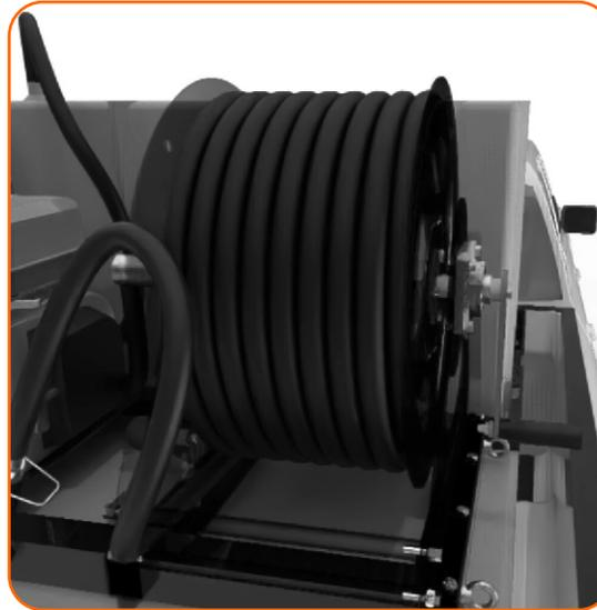
Descarga: Borracha sintética negra de alta pressão, resistente a óleo, intempéries, abrasão e raios UV. Diâmetro interno: Mínimo de 12,7mm, externo de 20,7mm. Alcance: 30 metros de comprimento. Pressão de trabalho: Mínimo de 2320 psi e 160 BAR. Pressão de ruptura: 640 BAR. Engates em latão, roscados e recravados nas extremidades.
