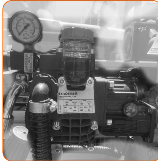
A bomba é autoescorvante, tipo membrana, com vazão 39 l/min e 40 BAR (580 PSI) de pressão. O peso aproximado é de 6,6kg.
