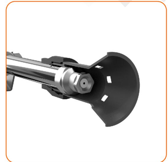
O bico é produzido em latão, com clichê em cerâmica e furo de Ø1,5 mm, Ø2,5mm ou Ø3,5mm que proporciona uma pressão de até 60 BAR ou 870 PSI.
