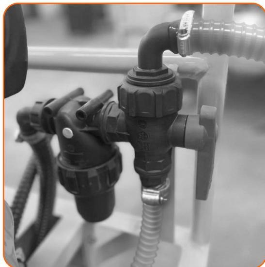
Filtro de linha (hidrojeter) permite o autoabastecimento do tanque, Autoabastecimento com mangote de sucção de 5 metros no mínimo. Possui 2 tipos de filtro sendo um filtro externo com tela plissada na entrada para a moto bomba e filtro malha na extremidade. Visor volumétrico para marcar o nível da água no tanque. Válvula c/ autoescorva.
