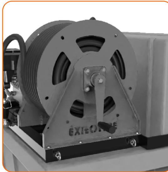
O carretel das mangueiras é formado por meio da união de chapas de aço SAE ABNT 1020, cortadas a laser, nas cores: **amarela, vermelho, laranja ou preta**, em geometria que sustentam a fixação dos outros componentes por meio de parafusos e porcas auto travantes.
